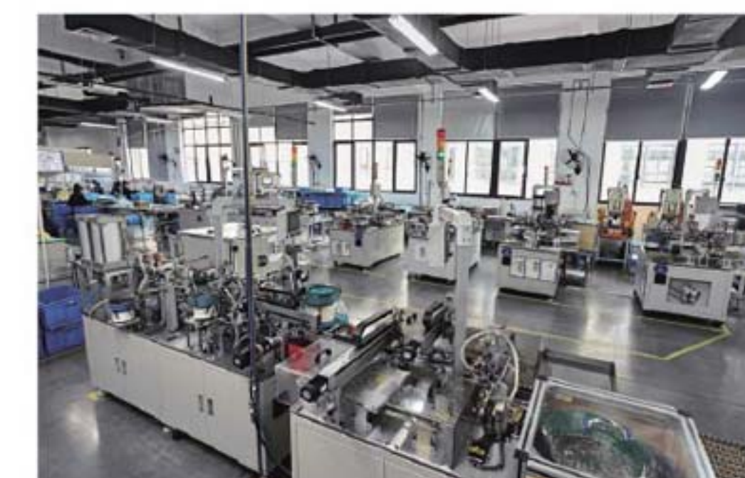
電磁閥先導頭自動組裝生產線
